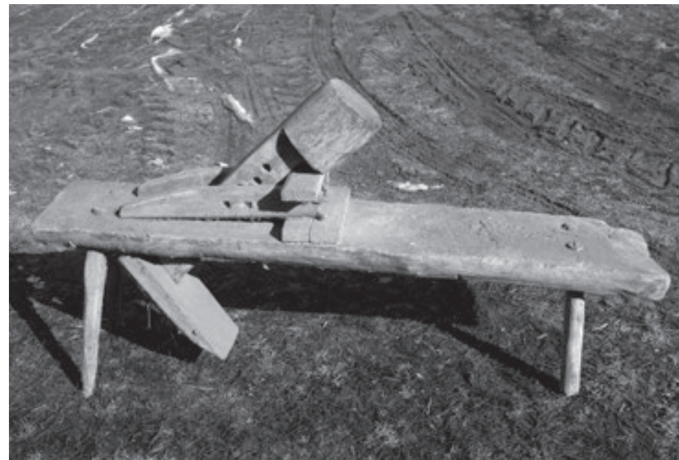
Il. 14. Ława do obróbki drewna (kobylica/ bykownica) pochodząca prawdopodobnie z te- renu Pyzdrskich Olędrow.
